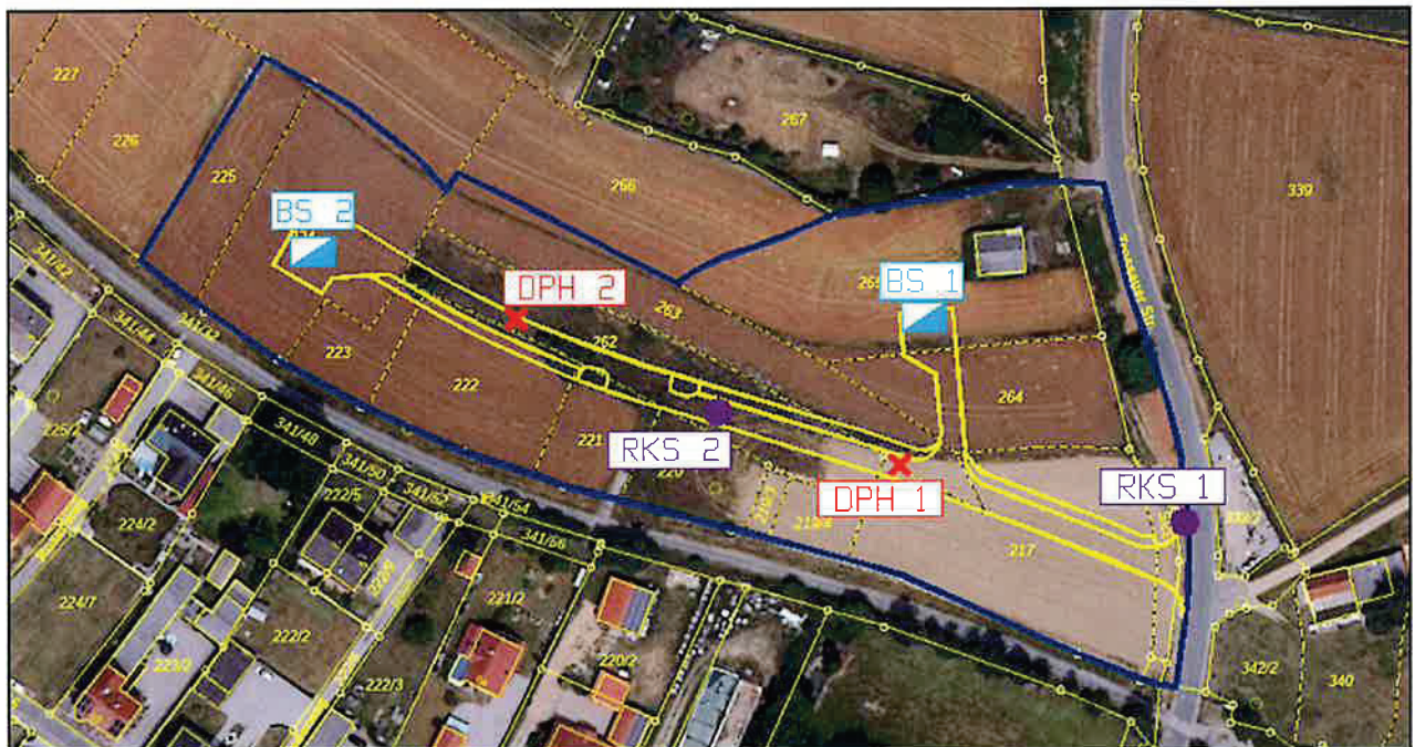
Abb. 1: Luftbild [U 2] des Baugebiets (Umgriff = blau, Straßen = gelb) mit durchgeführten Aufschlüssen (BS = hellblau, RKS = violett, DPH = rot) [U 2, U 5; modifiziert]
